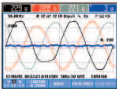
Afbeelding 2: golfvormen van de stroom (links) en de spanning (rechts) op alle fasen op het aansluitpunt vóór het schakelpaneel, met transiënte stroompiek en daaropvolgende spanningsdips
